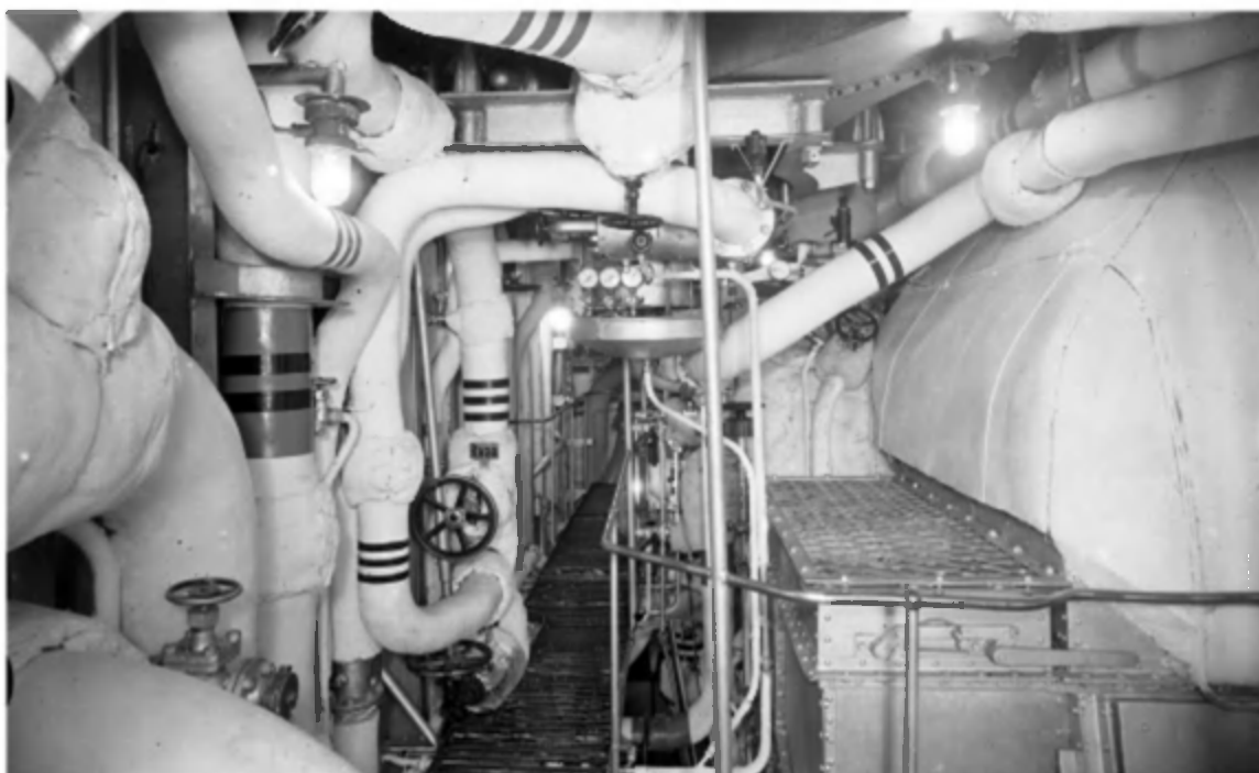
Fig. 28 – La parte alta di uno dei locali caldaie della corazzata Roma: i tubi con 3 strisce sono quelli del vapore surriscaldato. (foto Uff. Storico M.M. )
