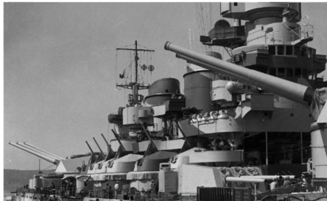
Fig. 16 – Particolare delle batterie dei cannoni antiaerei sul lato destro della nave da battaglia Roma . (foto Uff. Storico M.M.)
